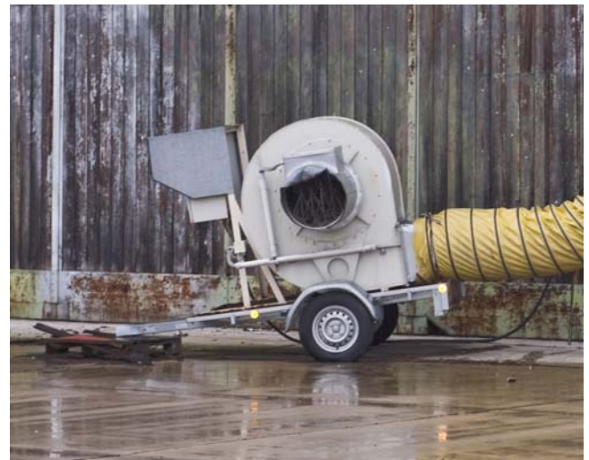
Bild 2: Ventilator, ca. 10.000m³/h
