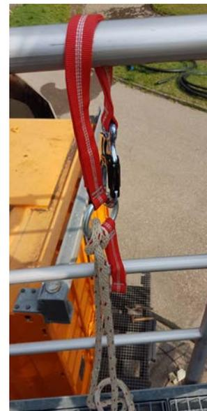
Wie beim Feuerwehr-Haltegurt kann sich der Schlauchtruppführer, nach erfolgreicher Rettung, durch aushängen der HMS-Sicherung aus der Sicherungskette befreien und nach unten steigen. Feuerwehrleine, Bandschlinge und Ringöse verbleiben am Übungsgerüst.
