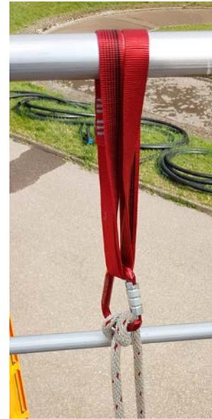
Der Schlauchtruppführer muss, nach erfolgreicher Rettung, nur seine Sicherung vom Übungsgerüst lösen und kann nach unten steigen. Feuerwehrleine, Bandschlinge und HMS-Karabiner verbleiben am Übungsgerüst.
