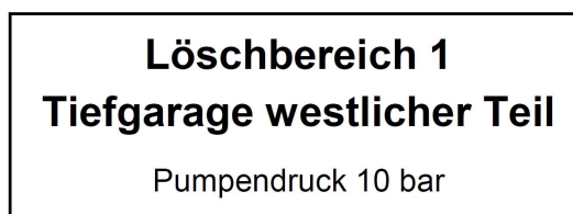
Abbildung 3: Beispiel für Kennzeichnung der Löschwasser-Einspeiseeinrichtung eines Löschbereichs bei Vorhandensein mehrerer Löschbereiche
