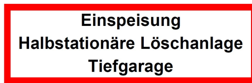
Abbildung 1: Kennzeichnung der Löschwasser-Einspeiseeinrichtung mit einem Schild
