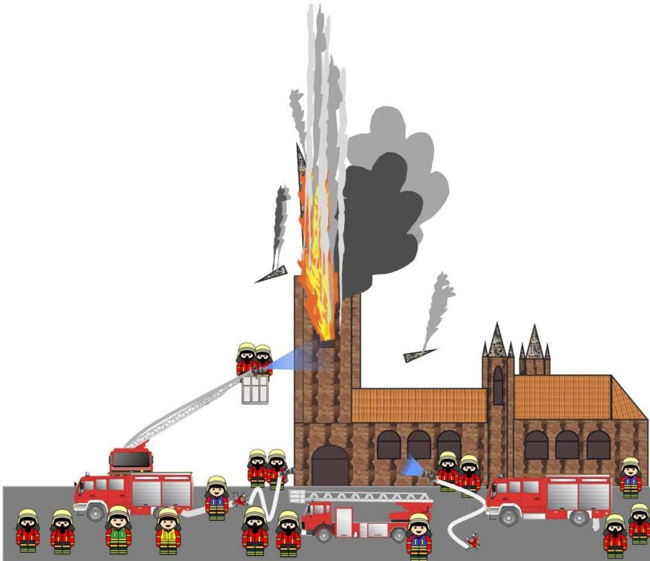
Abbildung 8: Bei einem Einsturz ist der Trümmerschatten besonders groß, je höher das Gebäude oder der Gebäudeteil ist!
