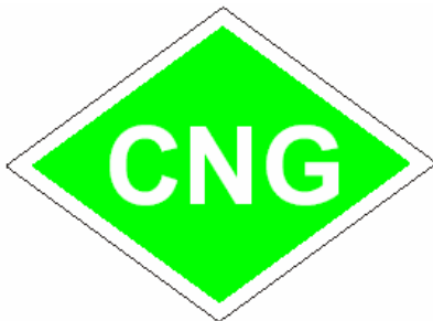
Bild 1 Kennzeichnung von mit Erdgas betriebenen Kraftfahrzeugen der Klassen M2 und M3 (Nutzfahrzeuge)
