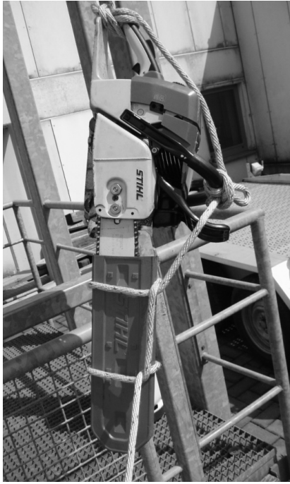
Mastwurf – Mastwurf – Halbschlag – Halbschlag
