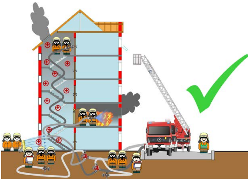
Abbildung 3: Ein mobiler Rauchverschluss wirkt sich auch positiv bei der Entrauchung eines Treppenraumes aus.
