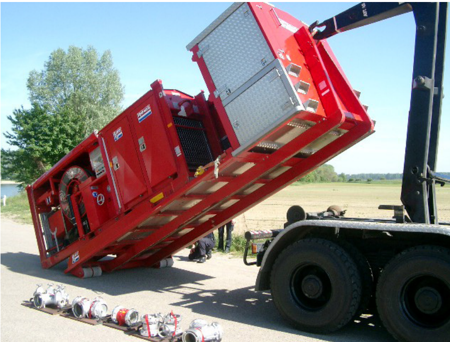
Abbildung 24: HFS beim Absetzen der Pumpeneinheit an der Wasserentnahmestelle.
