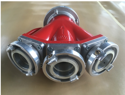
Abbildung 4: Sammelstück mit federbelasteten Einzelklappen (nach DIN SPEC 14355).
