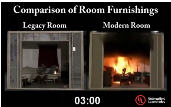
Video: Brandversuch in Wohnräumen mit altmodischen Einrichtungsgegenständen im Vergleich mit modernem Mobiliar.
