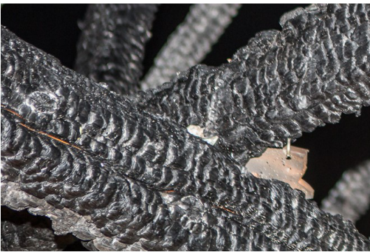
Abb. 2 2 : Holzkohleschicht an Verbrannten Holzbalken
