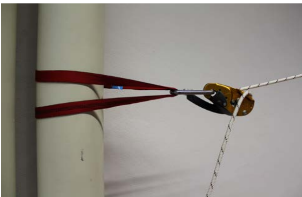
Anschlag: Sicherungsgerät Petzl (Das Sicherungsgerät wurde aus Darstellungsgründen nicht gesichert oder festgelegt)
