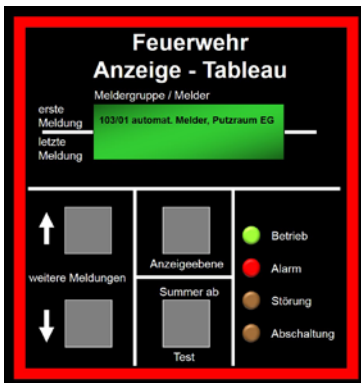
ABBILDUNG 9: FEUERWEHRANZEIGETABLEAU BEI ALARM
