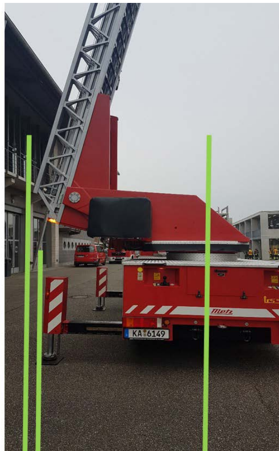
BILDER 8+9: MINIMALE UND MAXIMALE ABSTÜTZUNG ZUR DREHKRANZMITTE
