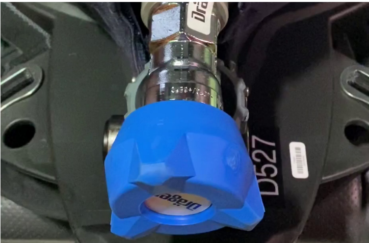
Abbildung 2: Sicherheitshandrad in eckiger Bauform. Die blaue Farbe zeigt eine eingebaute Abströmsicherung an.
